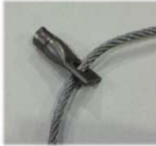
Figure 1 : Fixation type douille + câblette pour CCV projeté
